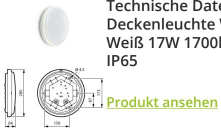
**Technische Daten Philips LED-Wand- und Deckenleuchte WL070V Ledinaire Plastik Weiß 17W 1700lm - 830-840 CCT | 285mm - IP65**
